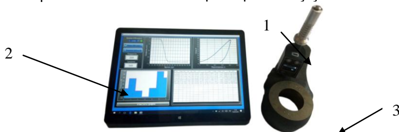
Рисунок 1 – Внешний вид прибора для контроля характеристик чугуна: 1 – датчик-твердомер ТПЦ-7, 2 – электронный блок, 3 – образец
